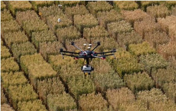
Ein Hexacopter nimmt im Juli 2020 auf einem Feld in der Schweiz Wärme- und Farbbilder von Weizenparzellen auf. (Bild: © ETH Zürich / Norbert Kirchgessner, Helge Aasen and Achim Walter)
