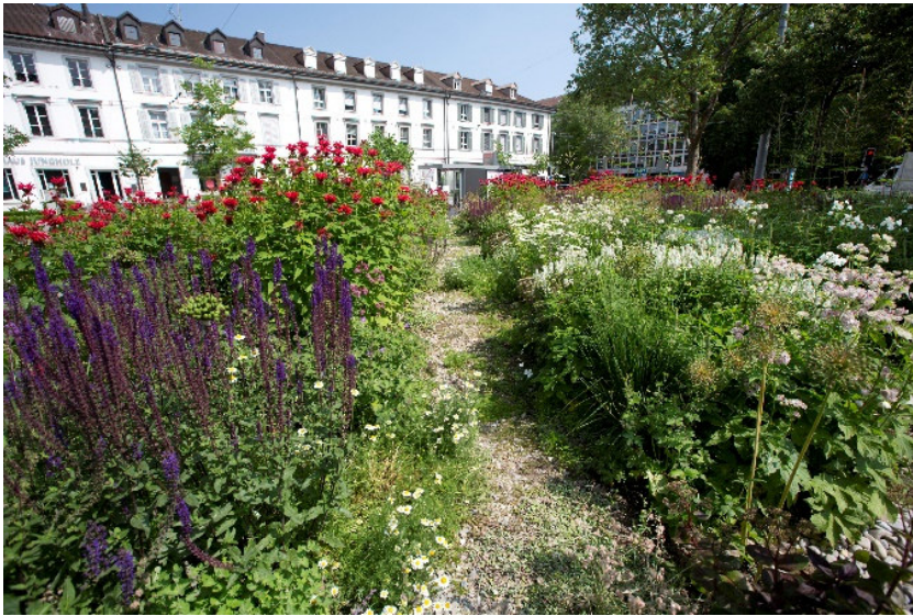
Bild: Grabenpärkli: Dank sickertfähiger Beläge gelangt das Regenwasser in den Untergrund
