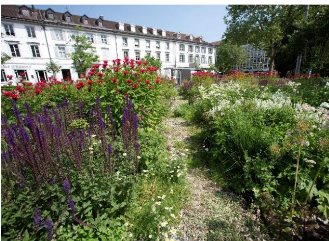
Grabenpärkli: Dank sickerfähiger Beläge gelangt das Regenwasser in den Untergrund
